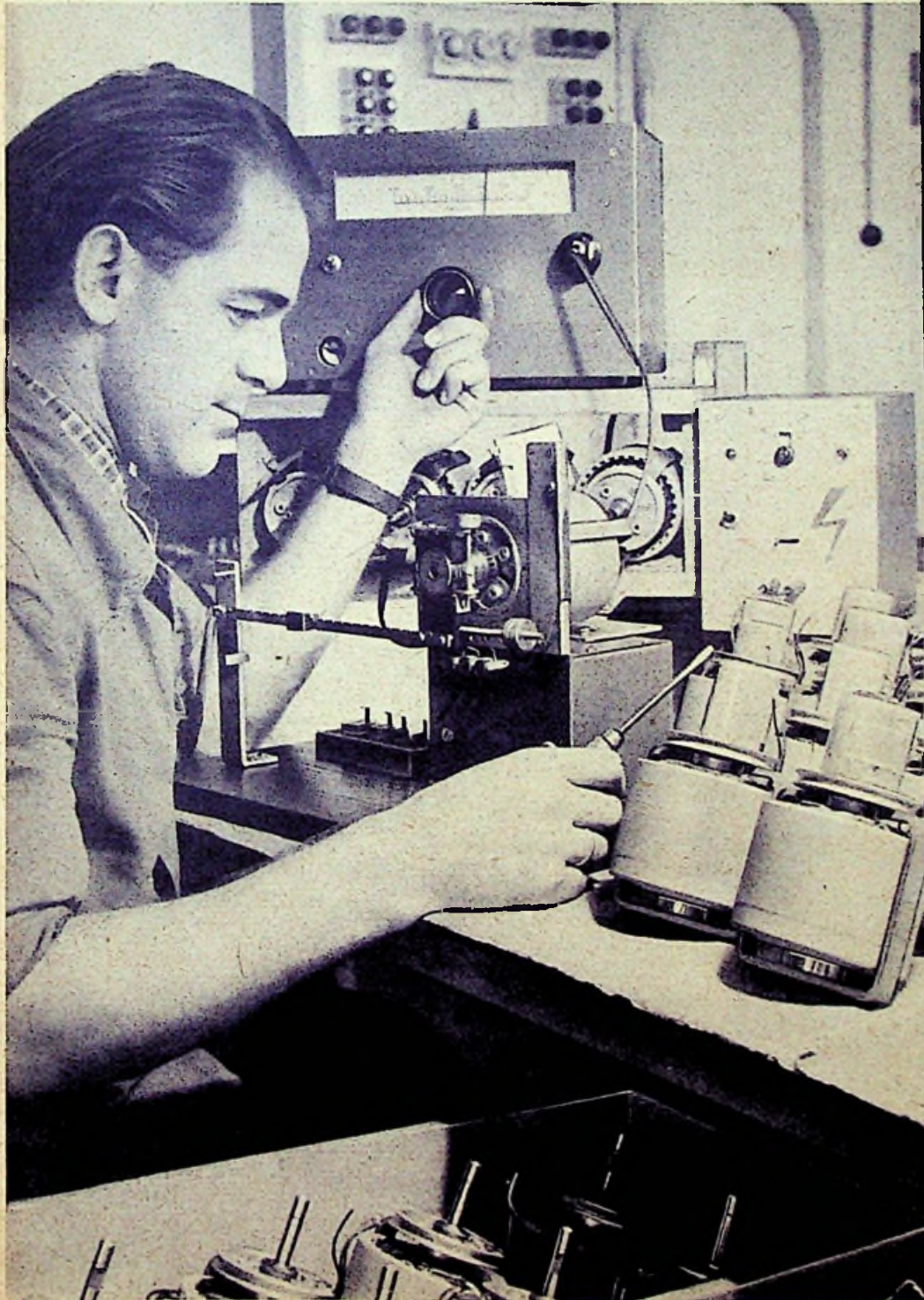
Prüfung der Laufeigenschaften von Motoren für Drahttongeräte. Die Drehzahl wird bei verschiedenen Belastungen stroboskopisch mit der Frequenz eines Tongenerators verglichen. Bei Belastungsschwankungen bis zu 40% darf sich die Drehzahl um höchstens 1% ändern. (Werkaufnahme Schaub)
