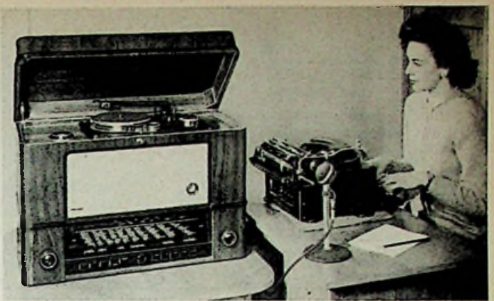
Links: Bild 8. Drahtton- und Schallplatten-Schaltulle mit Empfangsteil (Lorenz)
