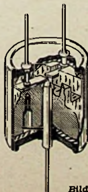
Bild 2. Erzeugung von Oberwellen mit Germaniumdioden
