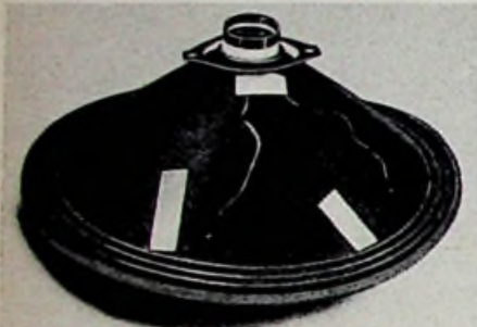
Bild 2. Das Festlegen der Anschlußenden der Schwingspule und das Kleben von leichten Rissen in der Membrane durch Tesaflexstreifen
